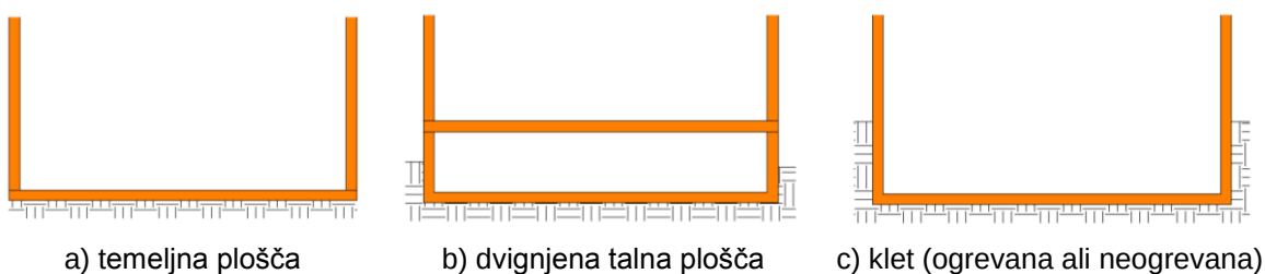
Slika 3.9: Konstrukcijske izvedbe podkletitve oziroma pritličja
